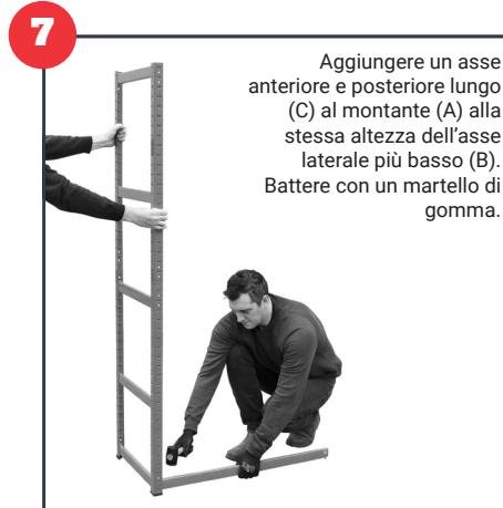
Aggiungere un asse anteriore e posteriore lungo (C) al montante (A) alla stessa altezza dell'asse laterale più basso (B). Battere con un martello di gomma.
