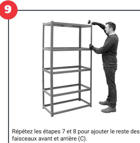
Répétez les étapes 7 et 8 pour ajouter le reste des faisceaux avant et arrière (C).
