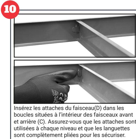
Insérez les attaches du faisceau (D) dans les boucles situées à l'intérieur des faisceaux avant et arrière (C). Assurez-vous que les attaches sont utilisées à chaque niveau et que les languettes sont complètement pliées pour les sécuriser.
